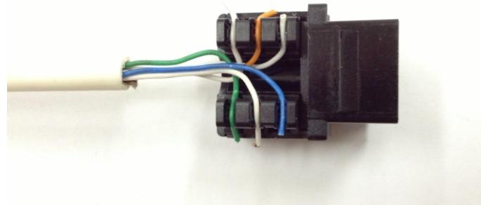
Pre bezporuchovú činnosť dbajte, aby konektory pripájané do zásuvky vyhovovali norme IEC 60603-7-x.
