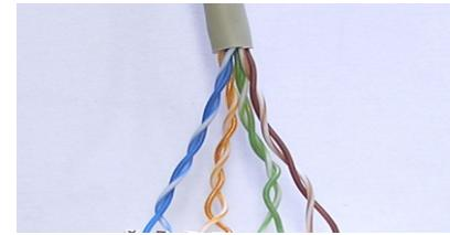
Kovový jazyček konektora vsuňte medzi tienenie a fóliu. Vodiče uložte podľa farebného značenia na bočných stranách konektora, schéma A alebo B. Rozdiel medzi A a B je, že oranžové a zelené páry vodičov sú zameniteľné. Upevnenie vodičov je samozárezové. Zárezové pole je typu DUAL a je možné použiť zárezový nôž LSAi 110.
