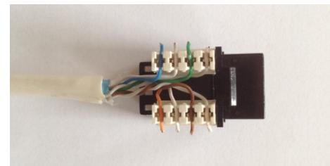
Uistite sa, že vodiče sú v správnej pozícii, na konektor nasadte krytky a stlačte dole cez vodiče, kým nezapadne. Krytky zatlačia vodiče do drážok a tým zabezpečia ich bezpečné pripojenie. Nasadte kovový kryt. Na lepšie fixovanie kábla a vodičov v zárezových prvkoch použite sťahovací pásik.
