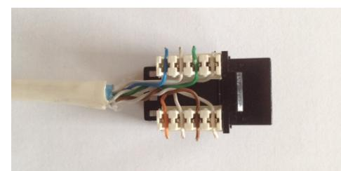
Uistite sa, že vodiče sú v správnej pozícii, na konektor nasadte krytky a stlačte dole cez vodiče, kým nezapadne. Krytky zatlačia vodiče do drážok a tým zabezpečia ich bezpečné pripojenie.
