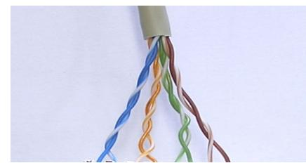
Vodiče uložte podľa farebného značenia na bočných stranach konektora, schéma A alebo B. Rozdiel medzi A a B je, že oranžové a zelené páry vodičov sú zameniteľné. Upevnenie vodičov je samozárezové. Zárezové pole je typu DUAL a je možné použiť zárezový nôž LSAi 110.
